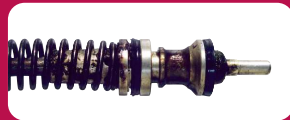
Вредные отложения и лаковый налет, образовавшийся в результате износа и окисления тормозной жидкости, ясно видны на поршне разобранного тормозного цилиндра.
