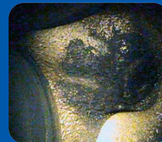
Топливная форсунка ДО проведения сервиса
