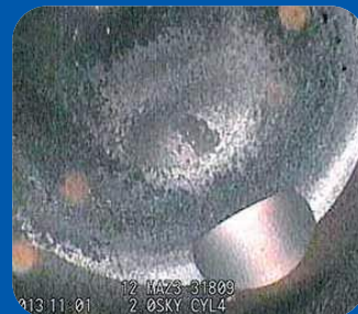
Головка поршня ДО проведения сервиса
