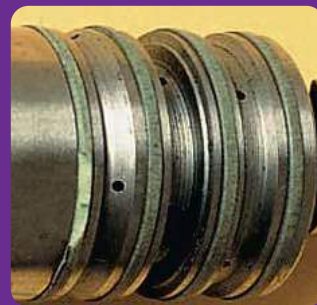
Золотниковый клапан гидроусилителя руля с затвердевшими уплотнителями.
