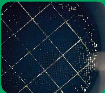
ДО: Сажа на экране сажевого фильтра
