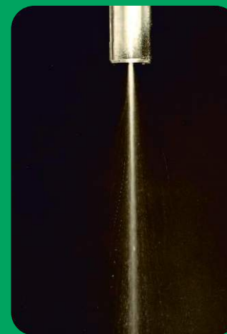
Неправильное распыление в результате накопления отложений на распылителе форсунки
