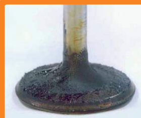
ДО: впускной клапан с карбоновыми отложениями
