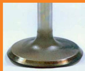
ПОСЛЕ: впускной клапан после проведения индукционного сервиса
