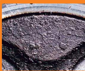
ДО: головка поршня с карбоновыми отложениями
