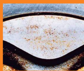
ПОСЛЕ: головка поршня после проведения индукционного сервиса
